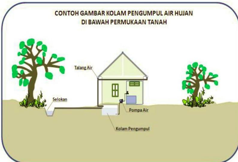
**Gambar 5. Contoh Kolam Pengumpul Air Hujan di Bawah Permukaan Tanah**
