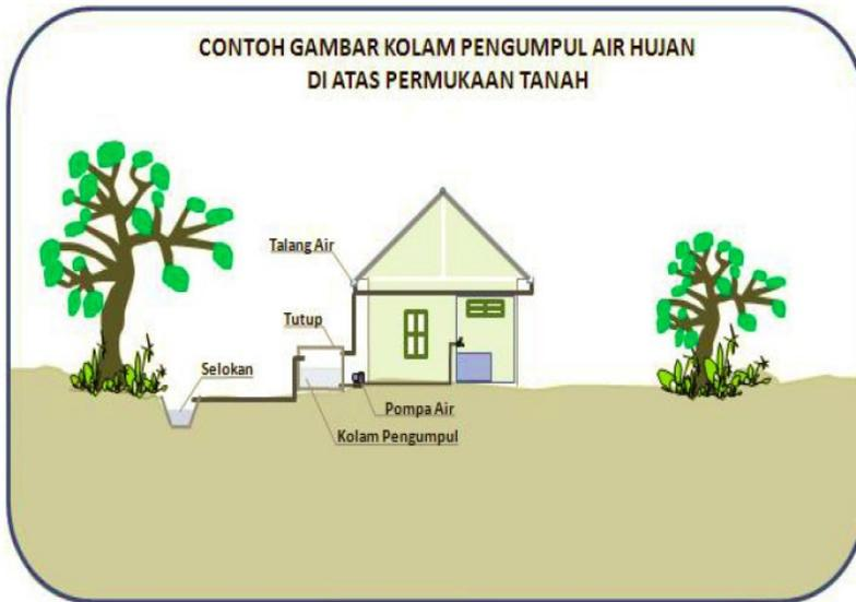
**Gambar 4. Contoh Kolam Pengumpul Air Hujan di Atas Permukaan Tanah**
